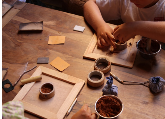
Remplissage du sable de fonte
